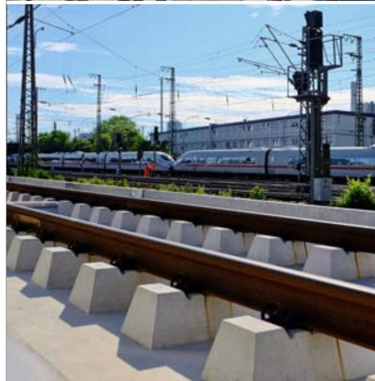
Das stelcon® Gleistragwannensystem RAIL PROTECT EW besteht aus Standardbetonfertigteilen mit einer Baubreite von 3,8 m und ist in unterschiedlichen Baulängen (2,4; 5,0; und 7,5 m) verfügbar.
