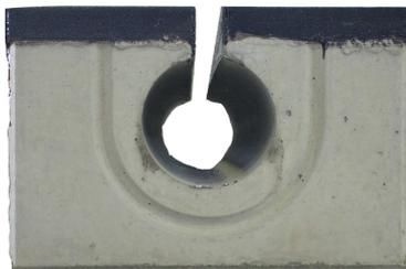
Betonfertigteil-Element mit einem umlaufenden Winkeleisenrahmen (45/45/4,5 mm, St-37) und einer 3 cm-Schlitzöffnung, Betongüte C45/55 LP, mit hohem Widerstand gegen Frost und Tausalze, Expositionsklassen XC4, XD3, XF4, bewehrt.
